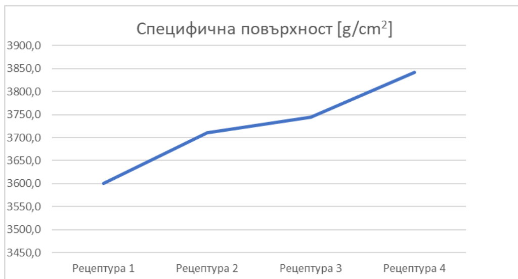
Фигура 7. Показва сравнителната графика от зависимостта на специфичната повърхност от количеството прахоунос.
