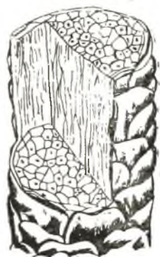
Фиг. 29. Напречно сечение и надлъжна схема на вълнено влакно
