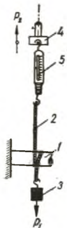
Фиг. 113. Определяне на коефициента на тангенциалното съпротивление при текстилни изделия
