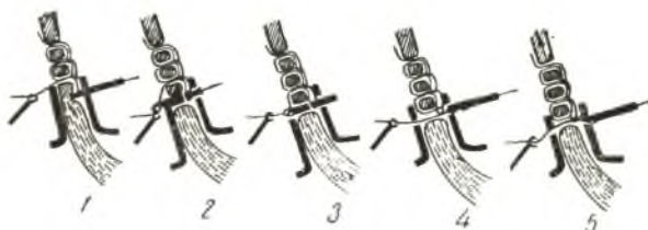
Фиг. 97. Схема на последователността на бримкообразуването:
