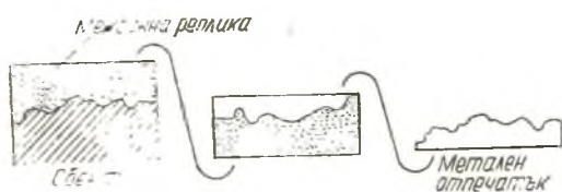
Фиг. 162. Позитивна двустъпална реплика
