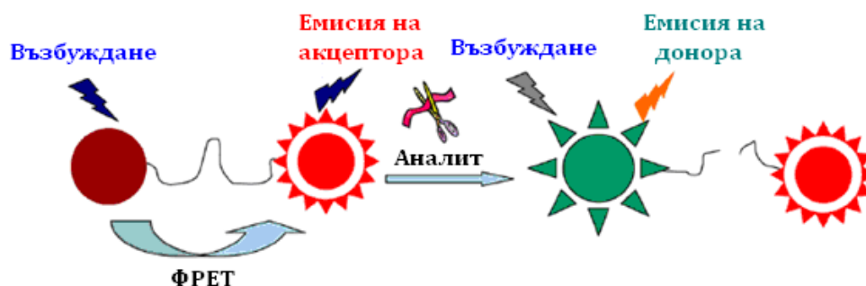
Фигура 24: Детекционен принцип на сензори, базирани на FRET, модулирани чрез разстояние между донора и акцептора. Ефективност на FRET според разстоянието между донор и акцептор.
