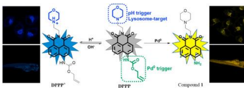
Фигура 61: Лизозомно-таргетиран флуоресцентен сензор за откриване на рН и паладий ( Pd^0 ).
