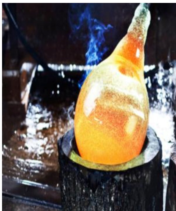
Фиг.2. Устно формуване на стъклен предмет.
