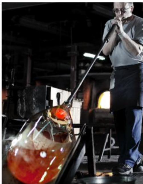
Фиг.3. Дооформяне на стъкления балон.
