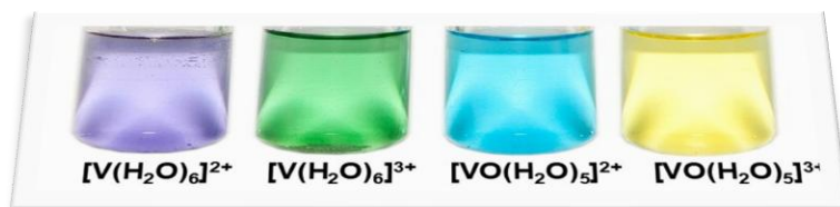
Figure 9 Nombres d'oxydation possibles du vanadium. De gauche à droite: couleurs des solutions aqueuses de composés contenant du vanadium dans quatre états d'oxydation différents (II, III, IV, et V).
