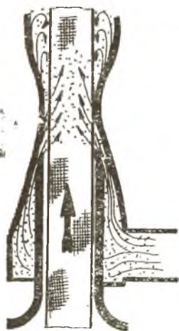
Фиг. 104. Схема на действие на дюзата
