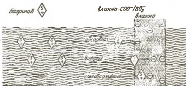
Фиг. 118. Схема на механизма на багрене на ПАН влакна с основни багрила
