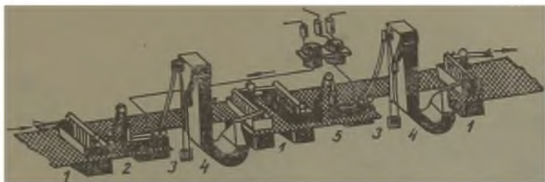
Фиг. 45. Схема на непрекъснат агрегат за избелване система „Du Pont“
