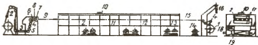
Фиг. 151. Схема на едноетажна ширилно-сушилна машина (планрама)
