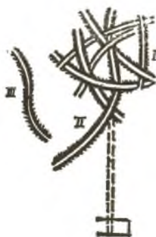
Фиг. 70. Схема на разплитанията на вълнените влакна в процеса на тепане
