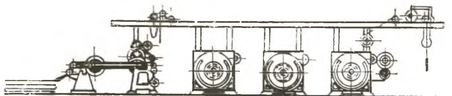
Фиг. 75. Схема на мокър декатир
