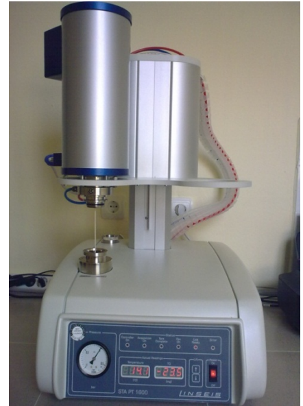
Фигура 26. Апарат STA PT1600 TG-DTA/DSC
