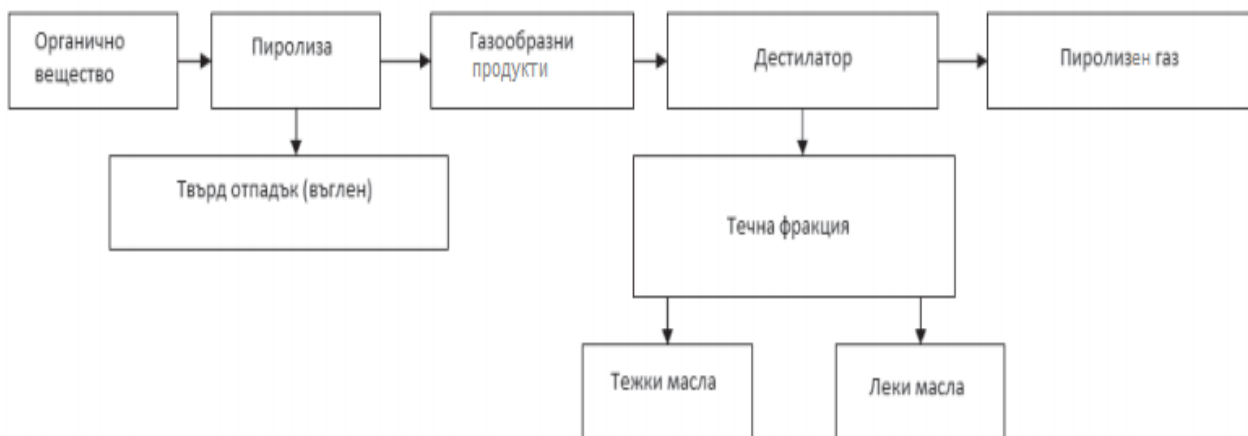
Фигура 9. Процес на образуване на крайните продукти чрез пиролиза [16]
